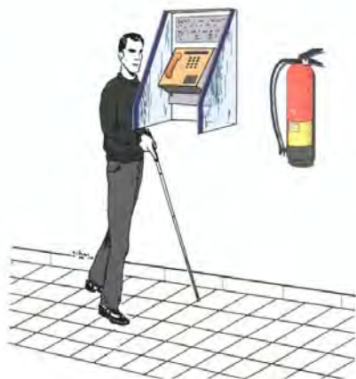
Mobiliario adosado a pared de forma incorrecta
