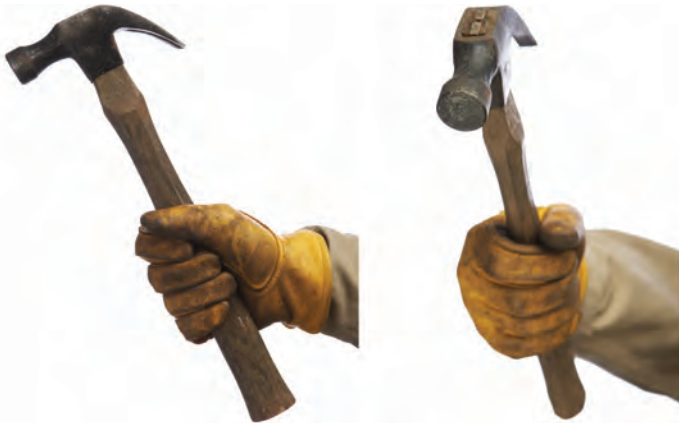
Figura 11. Agarre de un martillo: (a) Correcto; (b) incorrecto con la muñeca flexionada
