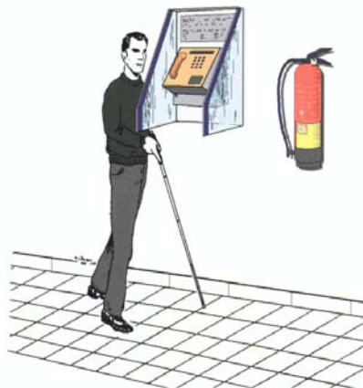
Mobiliario adosado a pared de forma incorrecta
