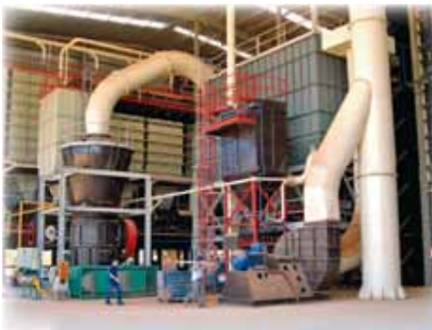
Molino pendular para coque de petróleo (por gentileza de Molaris).
