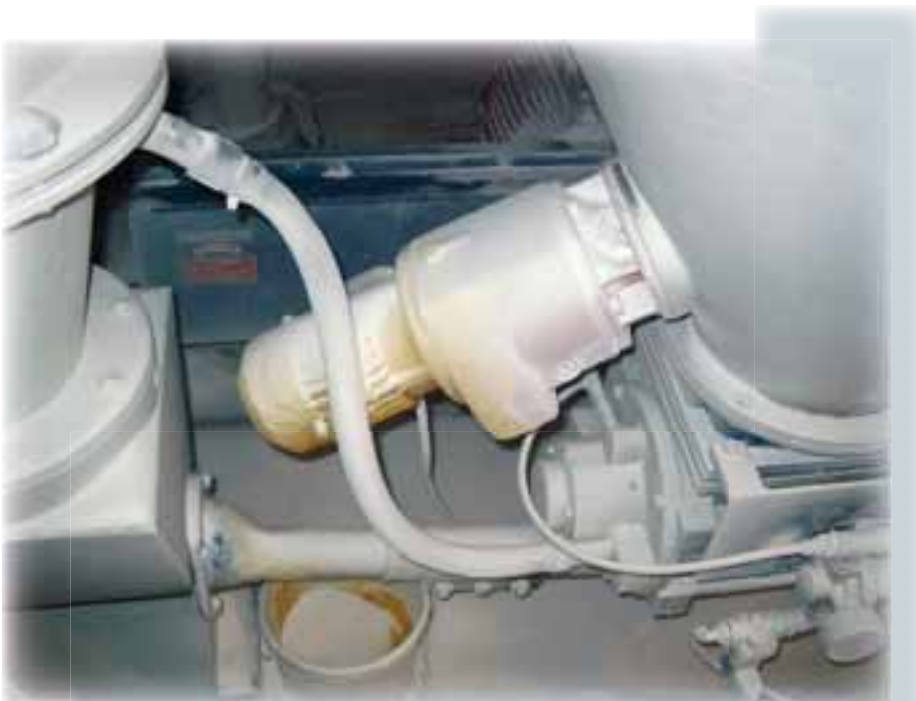
Espesor excesivo de capas de polvo sobre motor.
