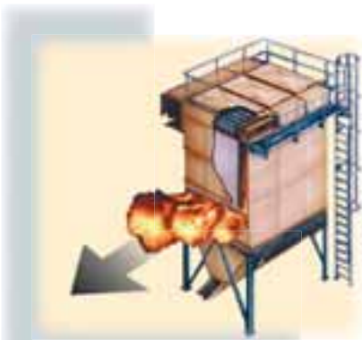
Ventoe lateral en horizontal.
