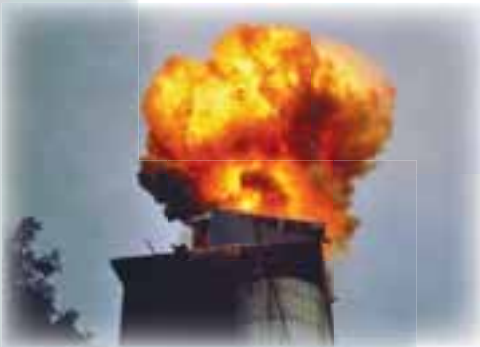
Explosión experimental realizada por el profesor Rolík K. Eckhoff y su equipo en silo de 500 m 3 en Boge, Vaksdal, Noruega.
