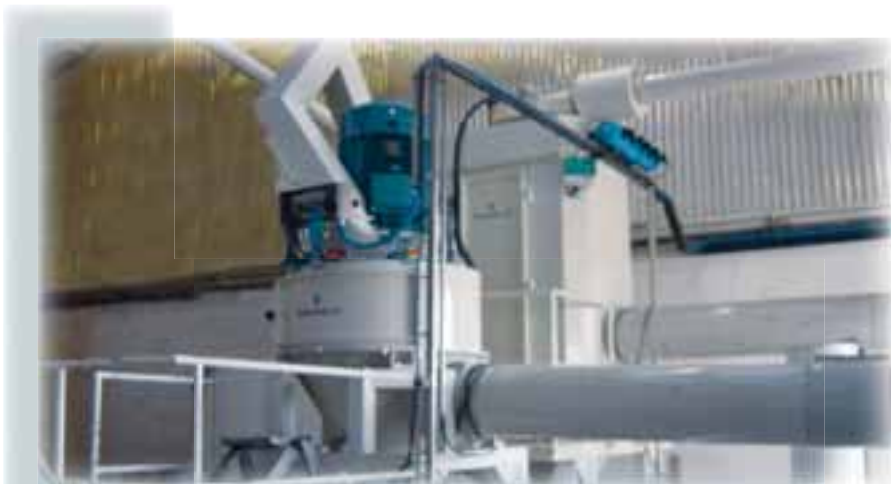
Molino y filtro con venteo conducido (por gentileza de Vimax).
