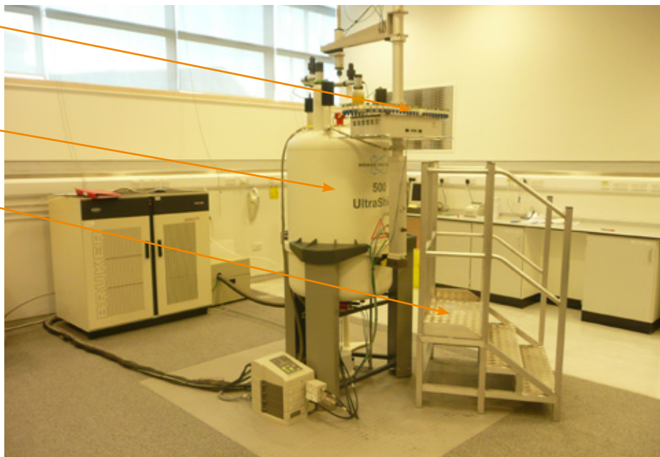
Figura 2.1. Unidad RMN, completa con cadena transportadora de muestras y plataforma de carga
