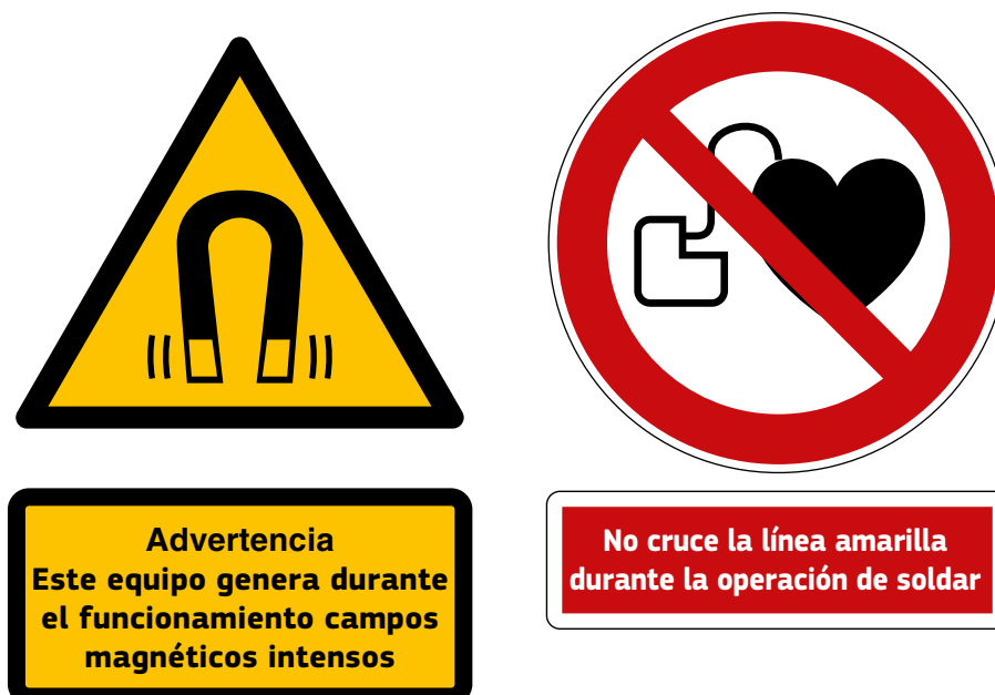
Figura 7.10. Ejemplos de señales de advertencia de campos magnéticos intensos e ilustración del símbolo de prohibición para las personas que lleven DMIA
