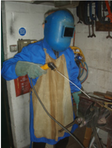
Figura 9.11. Ejemplos de buenas y malas prácticas en relación con el recorrido del cable de soldadura
