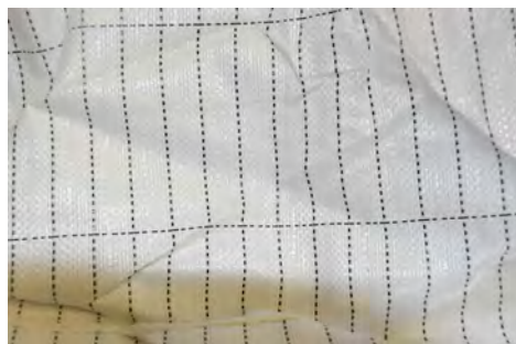
Figura 36. “Big bag” tipo C: marcado específico 53 e instrucciones de utilización; detalle del tejido conductor 54
