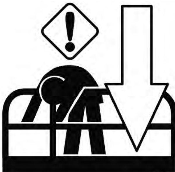
Ilustración 17: pictograma para la localización de los mandos de descenso de emergencia . Fuente IPAF.
