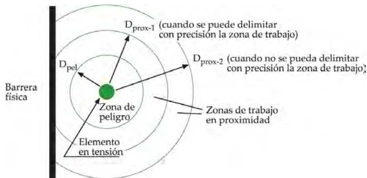
Figura 3b. Zona de proximidad (con barrera física)
