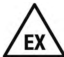
Figura 32. Señal de panel específica para emplazamientos con riesgo de incendio o explosión
