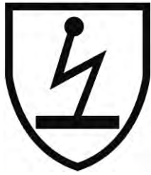
Figura 36. Pictograma relativo a equipos de protección individual antiestático que debe figurar en el marcado del equipo
